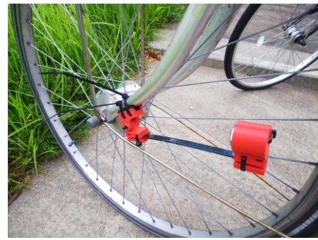
図2 ダンパーの使用例
