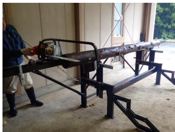
写真 1. STIHL 社の簡易製材機
