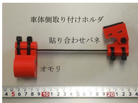
図1 製作したダンパー
