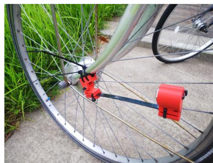
図2 ダンパーの使用例
