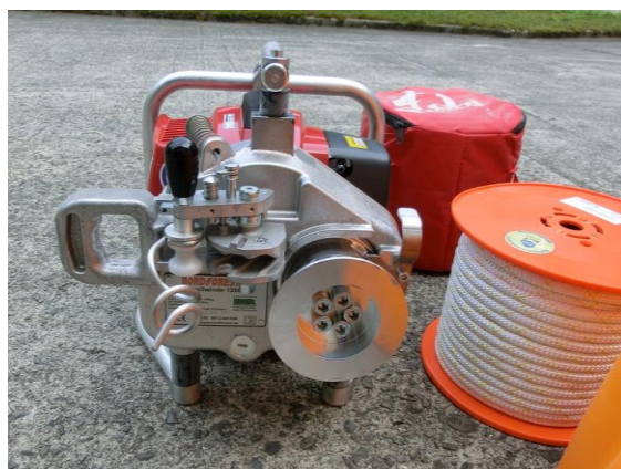
写真 2. ドイツ・グルーベ社の小型集材機
