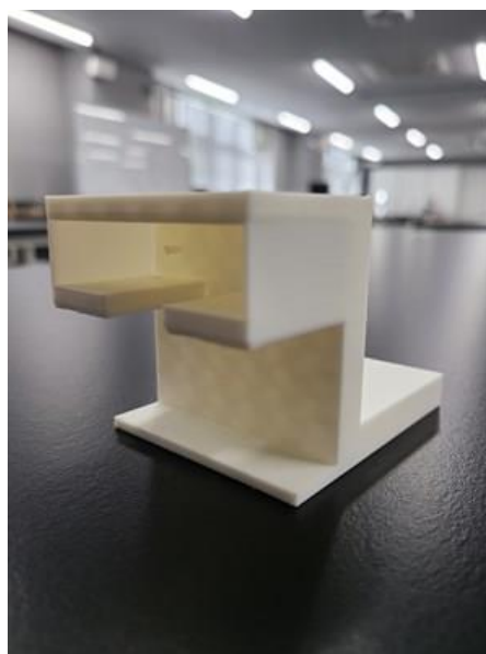
図3 光距離センサ固定用治具
