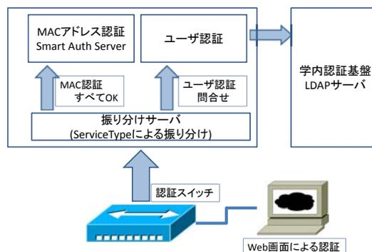
図- 3: 有線 LAN 認証用 Radius サーバ構成図
