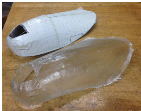
図12 FRP成型によるカウル試作
