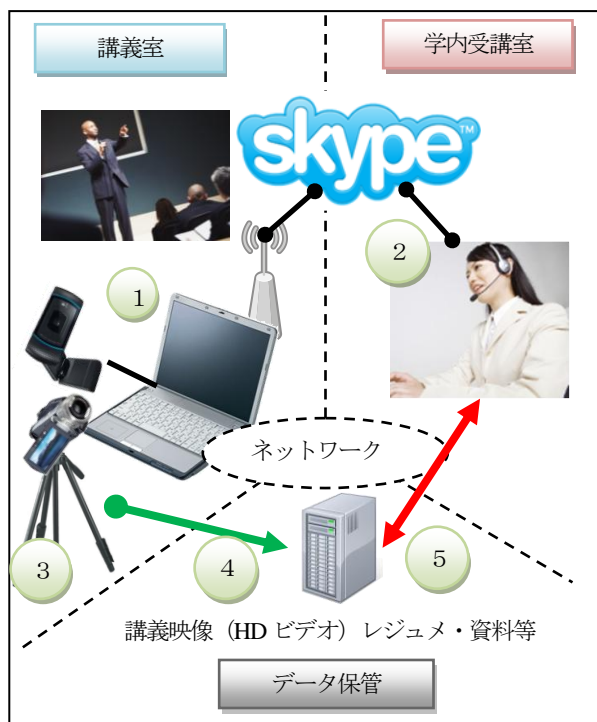
図 1 Skype による遠隔講義配信の構成 (図中の番号は表 1 に対応している)
